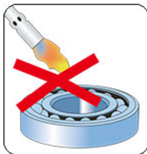
Nunca calentar un rodamiento con llama
